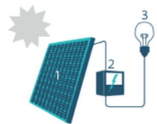
1. Zonnepaneel | 2. Omvormer | 3. Elektrische toestellen
